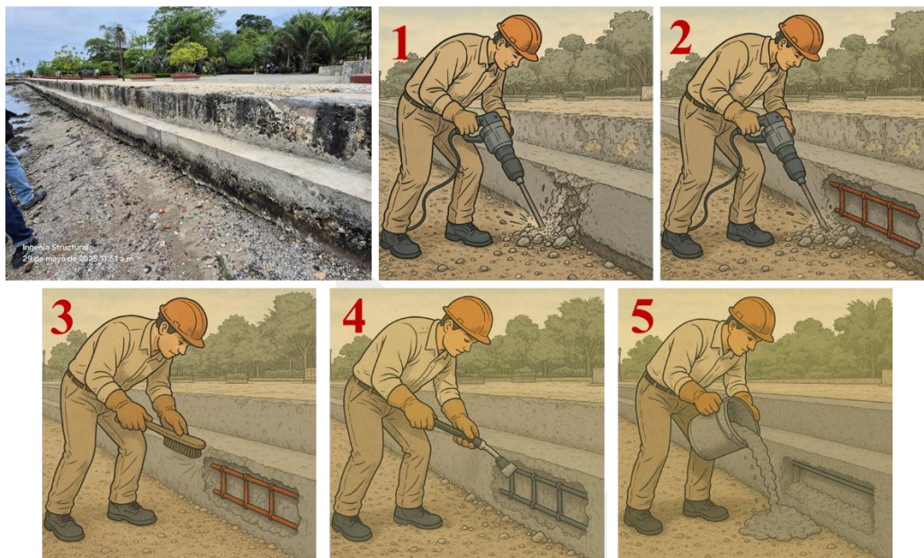
Figura 9. Esquema de Reparación. 1-2 Escarificaciones hasta el acero de refuerzo, 3-Limpieza de acero y/o colocación de nuevo acero, 4-Aplicación de recubrimiento en acero y barrera química en el concreto, 5-Colocación del concreto y/o mortero de reparación.
