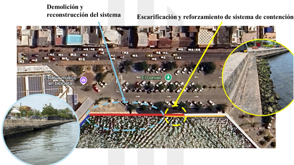
Imagen 5. Ubicación de intervenciones de demolición-reconstrucción del sistema en sector 5 y escarificación-reforzamiento en sistema de contención 5-6
