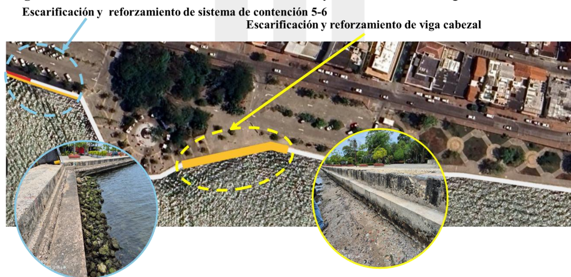
Imagen 3. Ubicación de intervenciones de demolición y reconstrucción de viga cabezal en sector 6
